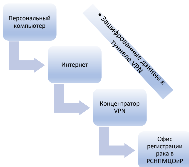
Рисунок 4. Модель реализации безопасности данных, при помощи VPN
