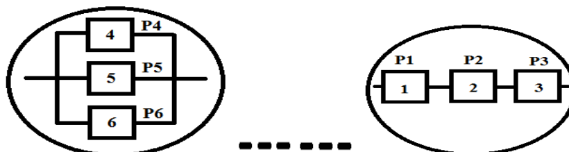
Рисунок 2 - Схемно-функциональный метод выбора основных элементов АЗМ: 1-одновинтовой насос; 2-привод; 3-предохранительно-перепускной клапан; 4-счетчик; 5-напорный рукав; 6-раздаточный кран.
