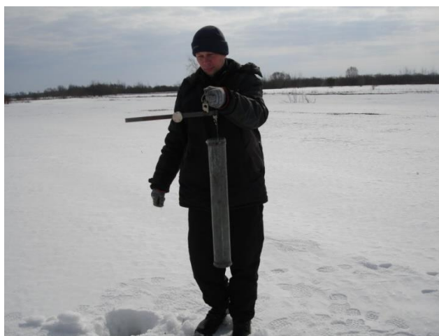
Рисунок 2. Определение плотности снега при помощи весового снегомера (земли АО «Московское» Рязанская область, 2019 год)
