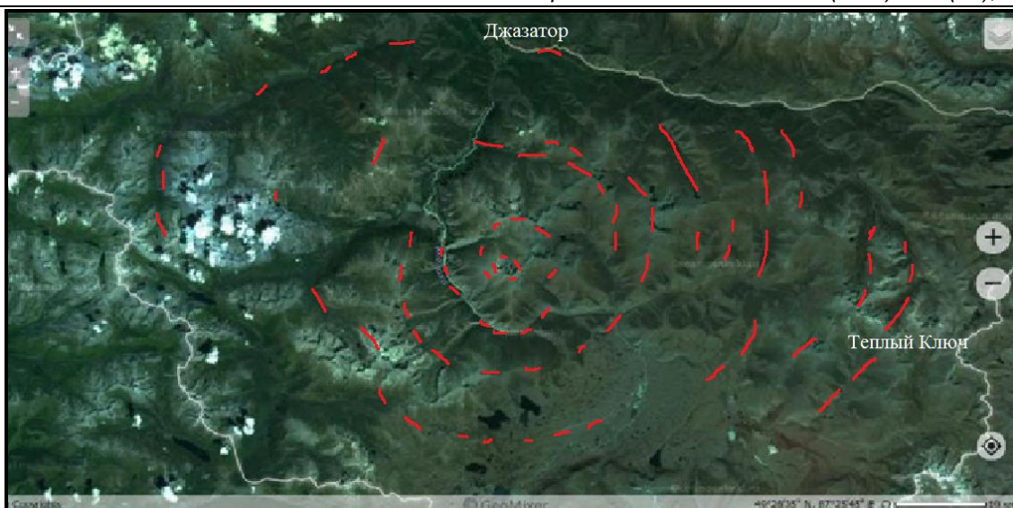
Рис. 3. Дешифрирование космоснимка ГУГЛ мумиенной трубы дегазации Укок: 49^{\circ} 28' 10'' и 87^{\circ} 25' 15'' , масштаб линейки 10 км
