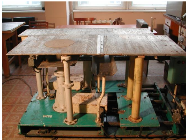
Рисунок 1 - Общий вид установки "Разлом" для моделирования процессов разломообразования в упруго-вязкопластичных моделях литосферы
