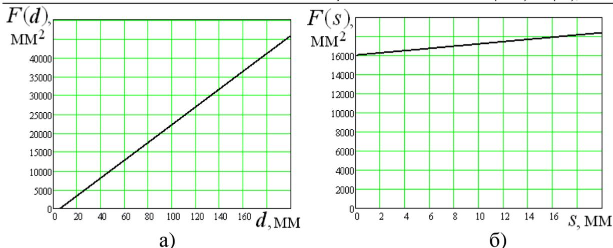
Рисунок 5. Графики зависимостей площади рабочей поверхности ходового винта и ходовой гайки  $F$ : а – от диаметра  $d$ ; б – от шага  $s$ .
