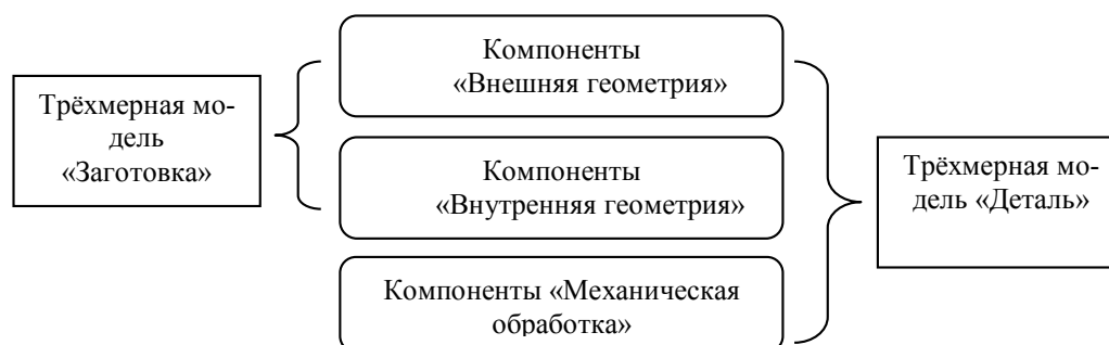
Рисунок 1. Схема методики трёхмерного моделирования, учитывающей технологический способ изготовления изделия
