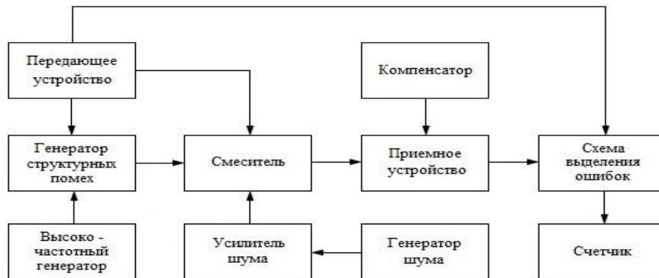
Рисунок 3 – Структурная схема экспериментального стенда
