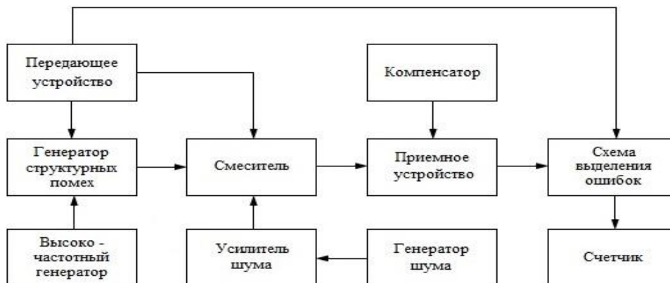
Рисунок 3– Структурная схема экспериментального стенда
