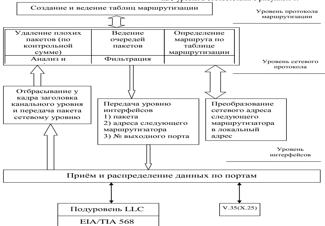
Рис. 1. Функциональная модель промышленного маршрутизатора
