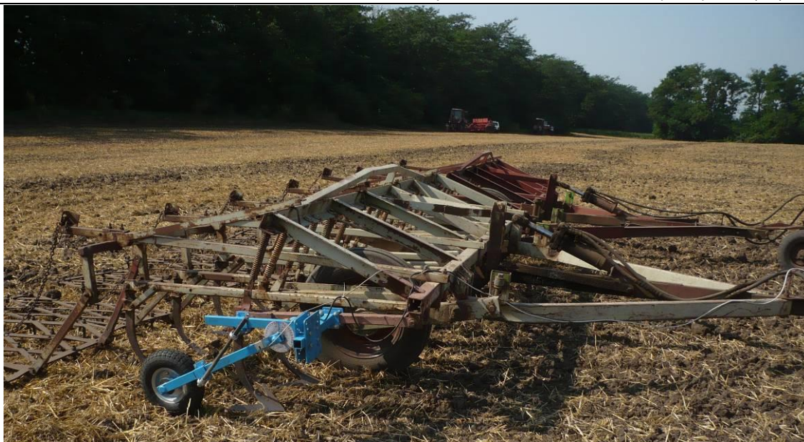
Рисунок 2 - Установка ИП-296 на раме культиватора КПС-4
