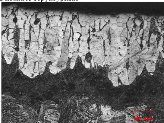
Рис. 3. Блочная микроструктура боридов после лазерной обработки.
