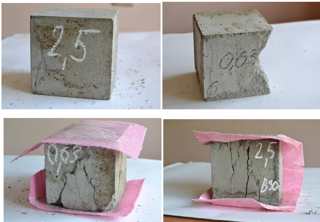
Рисунок 6. Внешний вид образцов из бетона В30, испытанных в стандартных и в условиях гидродинамического трения
