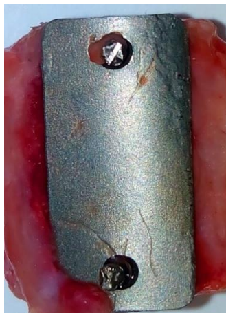
Рис. 1. Титановый имплантат сплошной структуры – отсутствие остеоинтеграции через 28 дней после операции
