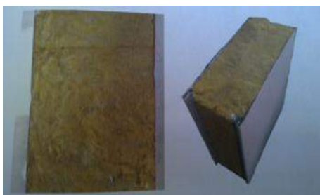
Рисунок 1. Фрагмент сэндвич-панели с нанесенной теплоизоляционной краской «Броня»
