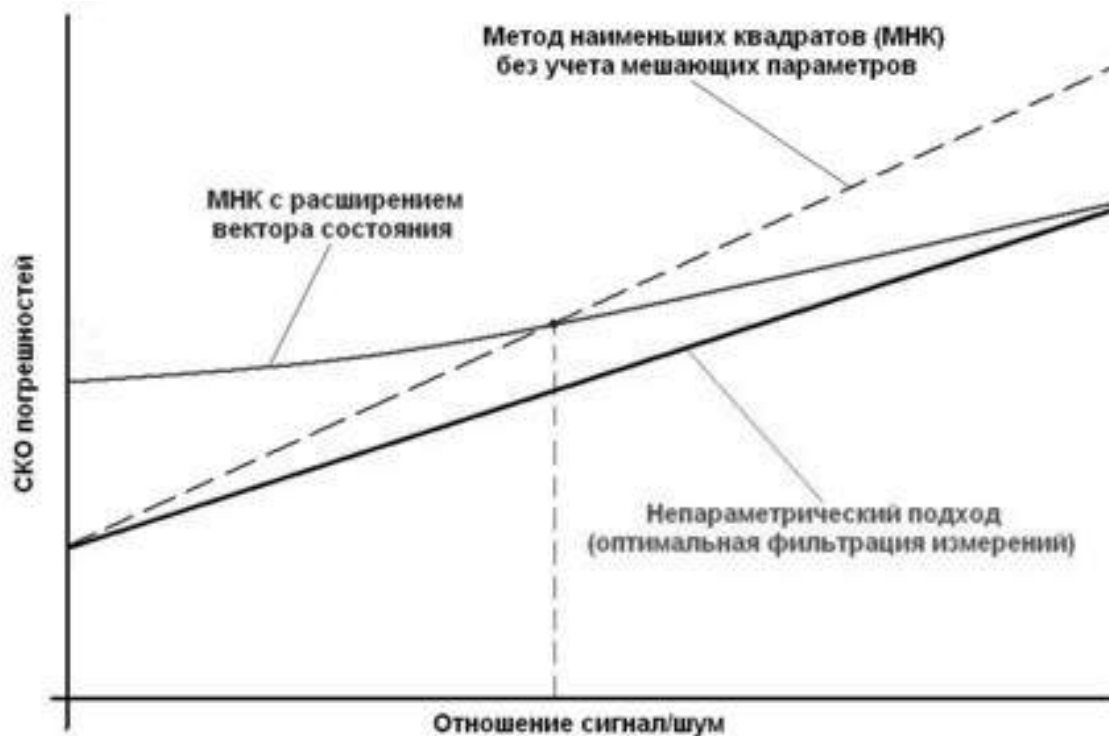
Рисунок 1. Зависимость погрешностей от уровня шумов при применении различных методов обработки измерений
